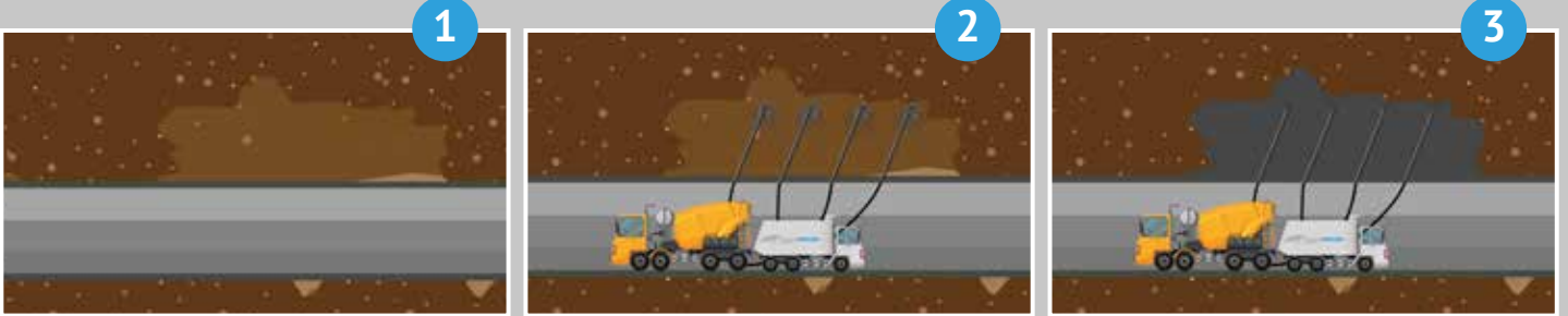
Underground Void Fill
